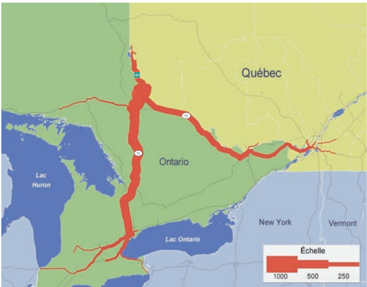
Figure 61 Flux de camions empruntant la route 101 à Témiscaming Semaine d'automne 1999
